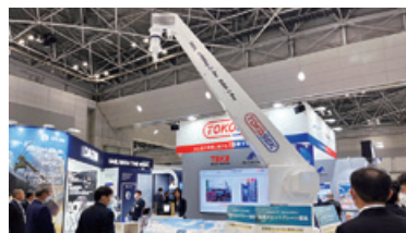
東光鉄工株式会社が製造する ダビットクレーン「TOKOSEK」 (写真提供：東光鉄工株式会社)
